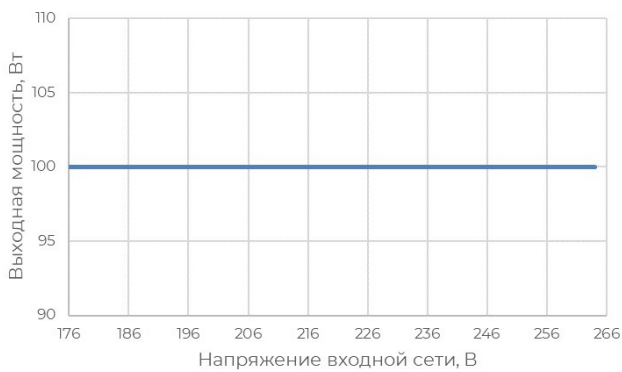
Рис. 1 - Зависимость выходной мощности от напряжения входной сети
